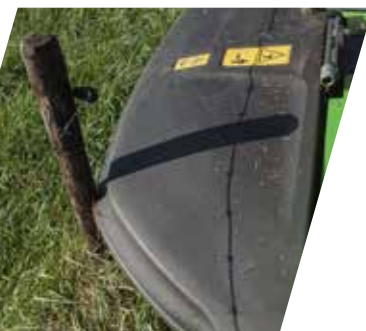
3 Copertura laterale flessibile FLEXPROTECT, ridisegnata e brevettata*.
