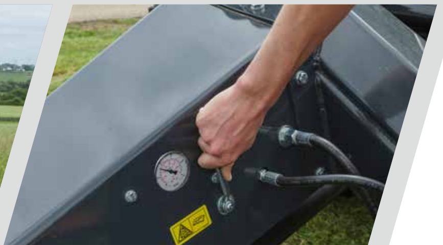
> Il sistema di sospensioni idro-pneumatiche LIFT-CONTROL.
