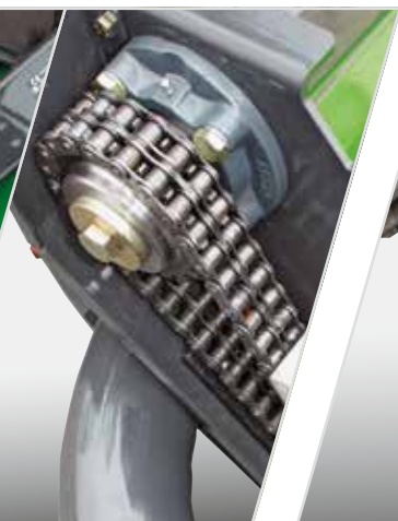
> Regolazione dell'intensità del condizionatore e della velocità del rotore.
