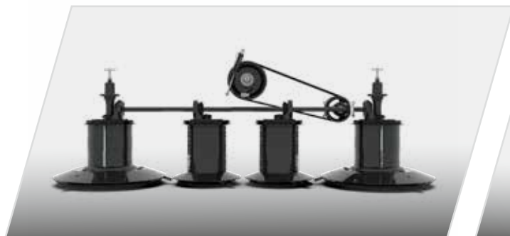
1 Cinghia trapezoidale con grandi cuscinetti da 40 mm e telaio robusto.
