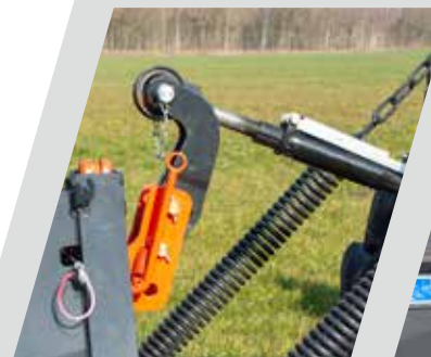
> 3° punto flessibile FLEXTOP (solo in combinazione con una testata di attacco fissa).
