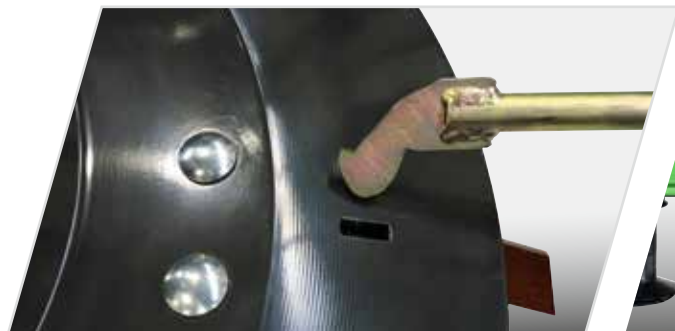
4 Meccanismo di sostituzione dei coltelli con uno speciale sistema porta-attrezzi e porta-coltelli.
