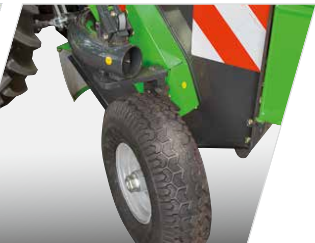
> Grandi ruote pivotanti per un perfetto adattamento al terreno.
