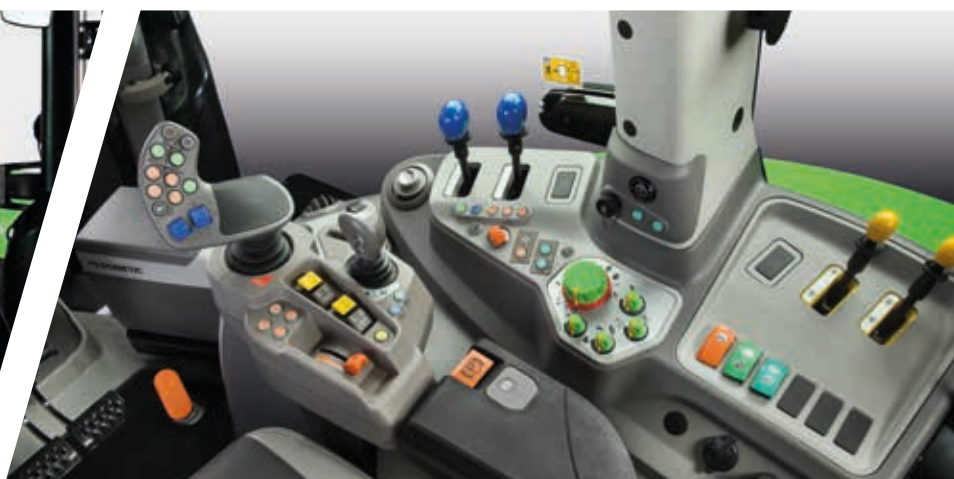
> Configurazione mista con 2 distributori meccanici e 2 elettrici.
