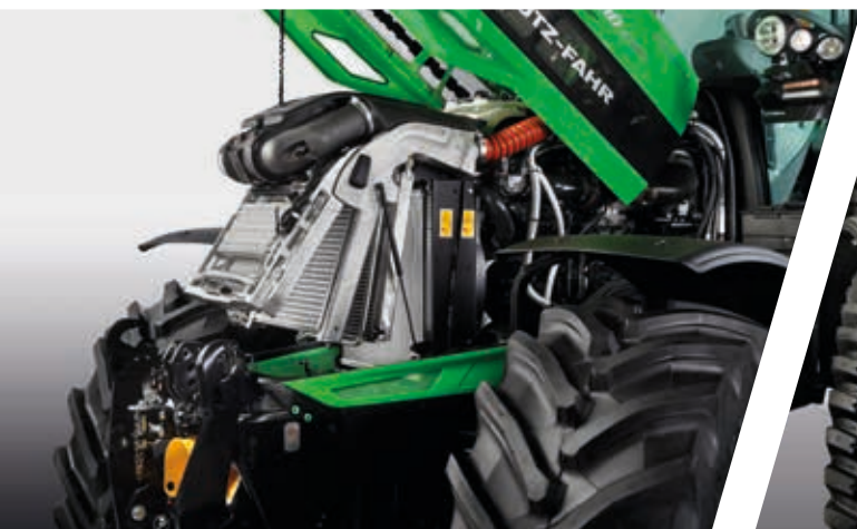
> Sistema di raffreddamento in alluminio Performance + con leva di sgancio azionabile con una mano per i modelli 6160-6190.
