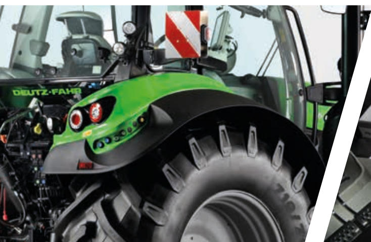
> Comandi esterni su entrambi i lati per sollevatore posteriore, presa di forza e fino a un distributore.
