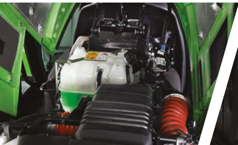
> Facile apertura di cofano e serbatoio del liquido di raffreddamento.
