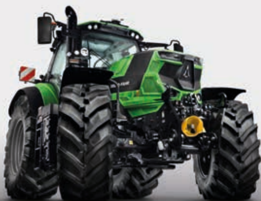
> Assale anteriore sospeso con bloccaggio al 100% del differenziale anteriore.
