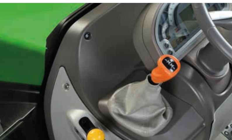
> Inversore meccanico con leva ergonomica su piantone sterzo.
