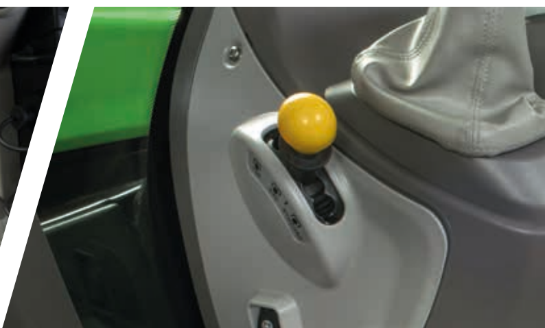
> Selettore velocità PTO in cabina.
