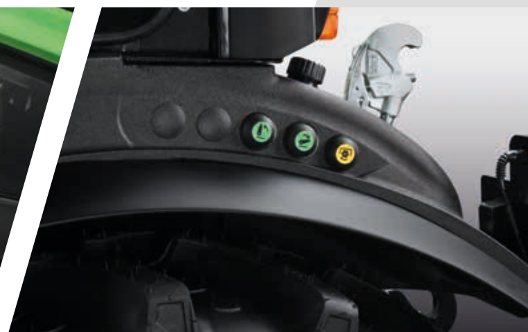
> Pulsanti esterni per sollevatore posteriore e PTO per agevolare le manovre di aggancio.
