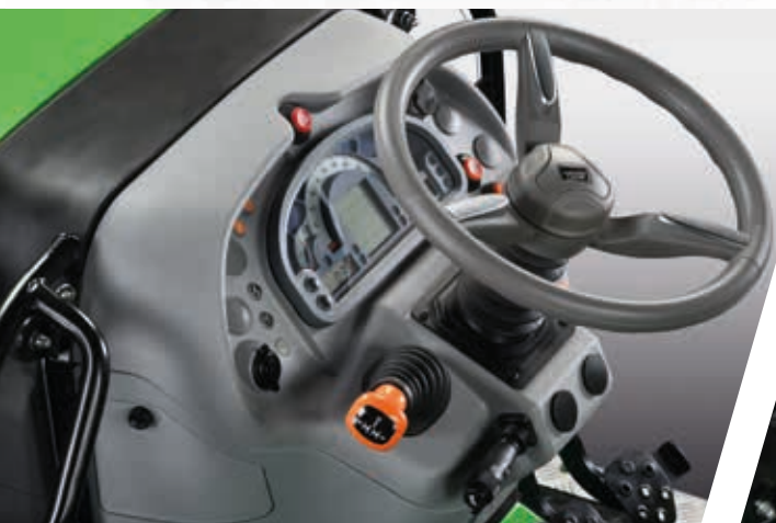
> Inversore meccanico con leva ergonomia su piantone sterzo.
