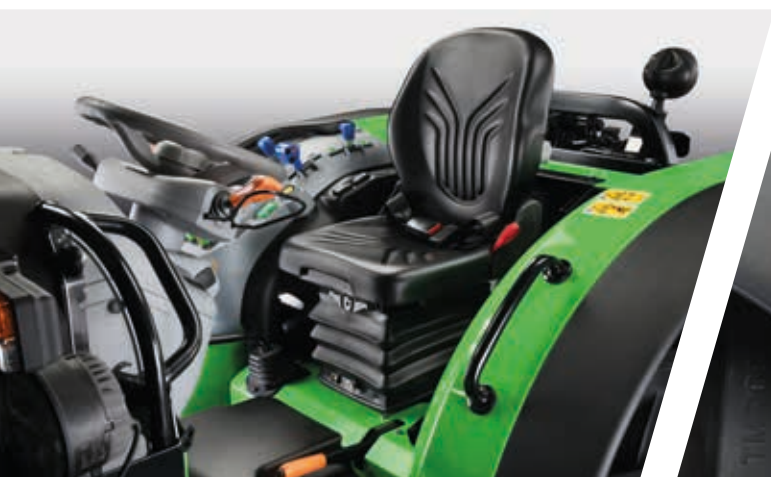
> Sedile di guida con sospensione pneumatica per un maggiore comfort.
