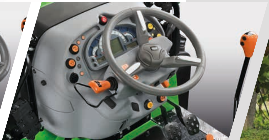
> PowerShuttle con SenseClutch con 5 livelli di regolazione.
