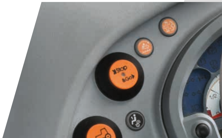
> La funzione Stop&Go è facilmente attivabile tramite un pulsante.
