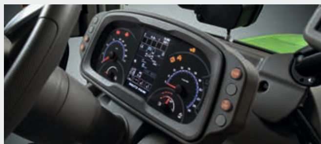
↑ Plancia analogica-digitale con le principali funzioni del trattore immediatamente visibili.
