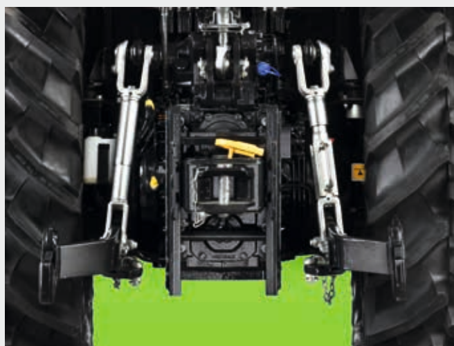
↑ Sollevatore posteriore compatto con tirante idraulico e stabilizzatori.
