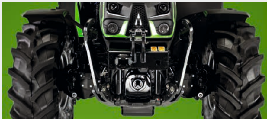
↑ I modelli 5D TTV possono essere equipaggiati con un sollevatore anteriore da 2100 kg di capacità e pacchetto comfort opzionale.
