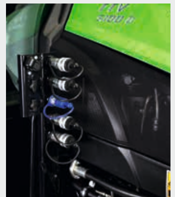
↑ Vie idrauliche a montaggio ventrale per attrezzi anteriori.
