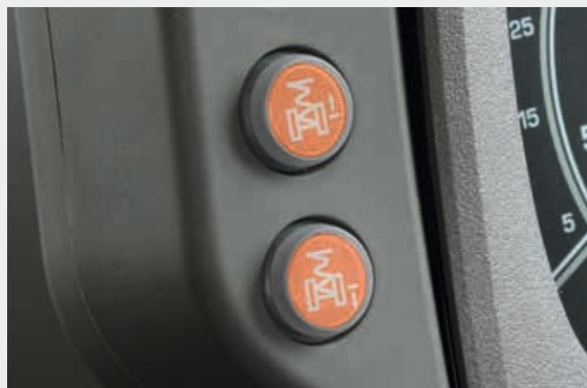
⬆️ Due nuovi pulsanti dedicati consentono la regolazione manuale della posizione della sospensione anteriore.
