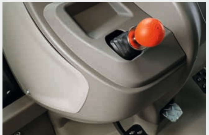
↑ Parcheggio sicuro anche in pendenza grazie al potente freno di stazionamento HPB.
