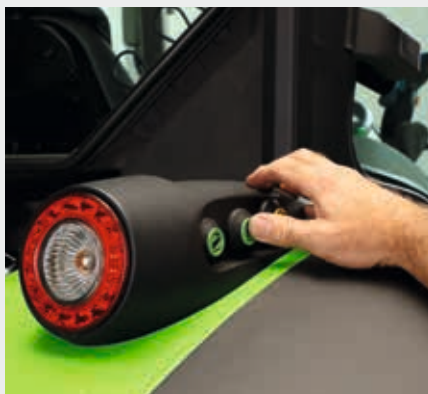
↑ Sollevatore posteriore e PTO hanno comandi esterni sui parafanghi posteriori.
