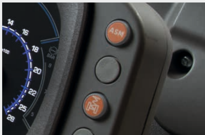
⬆️ Attivazione ASM e sospensione dell'assale anteriore.
