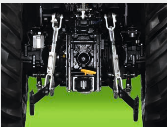
↑ Attacco a 3 punti standard per una maggiore capacità di sollevamento.
