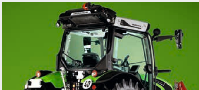
↑ Pannello tetto posteriore sollevabile per la massima visibilità superiore posteriore.
