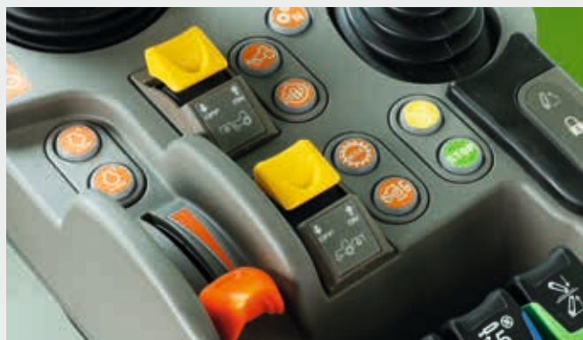
↑ Facile innesto della PTO anteriore e posteriore tramite pulsanti sul bracciolo MaxCom.
