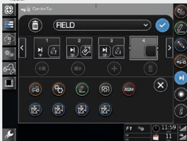
↑ Comfortip migliora ulteriormente il livello di comfort. Consente la registrazione di attività ripetitive e il loro richiamo con la semplice pressione di un pulsante.
