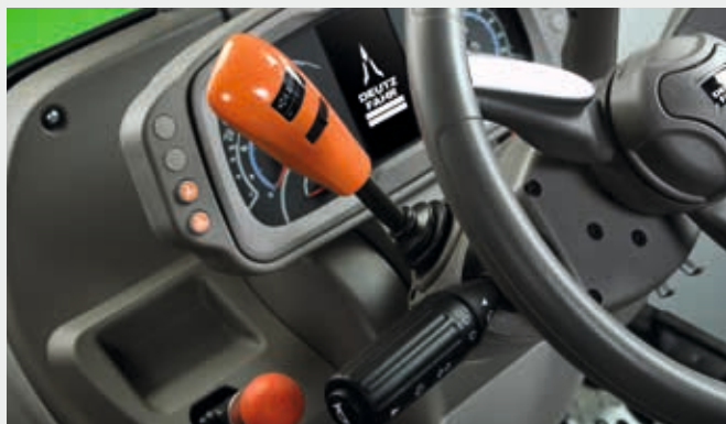
↑ SenseClutch: risposta personalizzabile di reattività ed efficienza della trasmissione.
