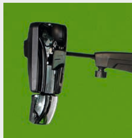
↑ Specchietti con regolazione elettrica e sbrinamento.
