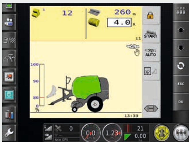
👉 Terminale universale per controllare qualsiasi attrezzo ISOBUS.
