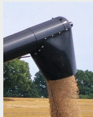
↑ Scarico, svuotamento dall'alto rapido ed efficiente.
