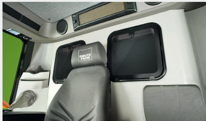
↑ Controllo visivo del serbatoio della granella. Una doppia finestrella in cabina permette di controllare visivamente il livello di riempimento del serbatoio e la qualità della granella raccolta.
